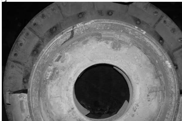
Рис. 2. Изношенная цапфа, подготовленная к ремонту
